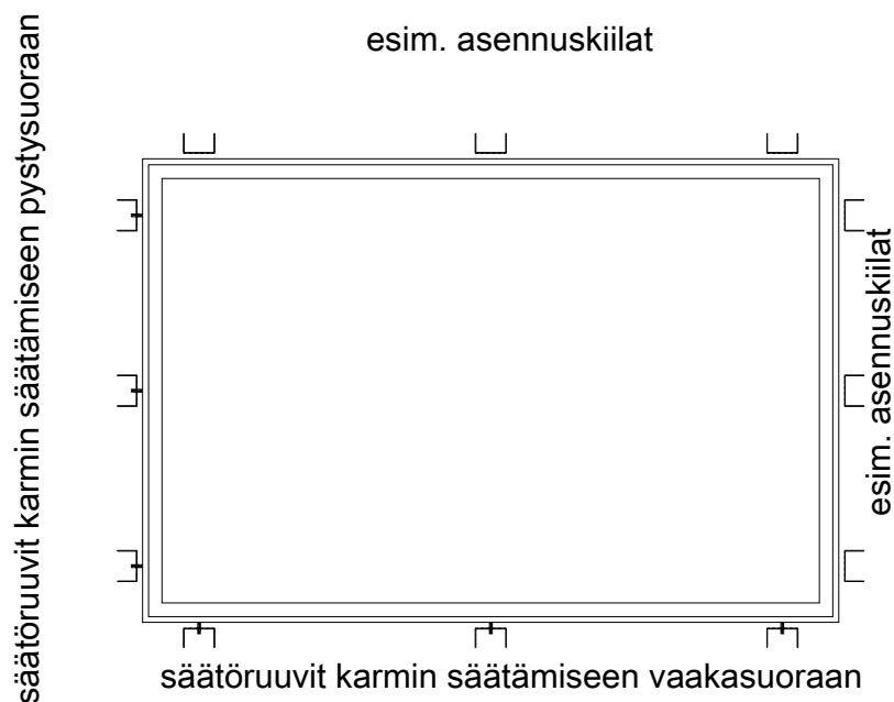
Kuva 11. Karmin asennus aukkoon.
